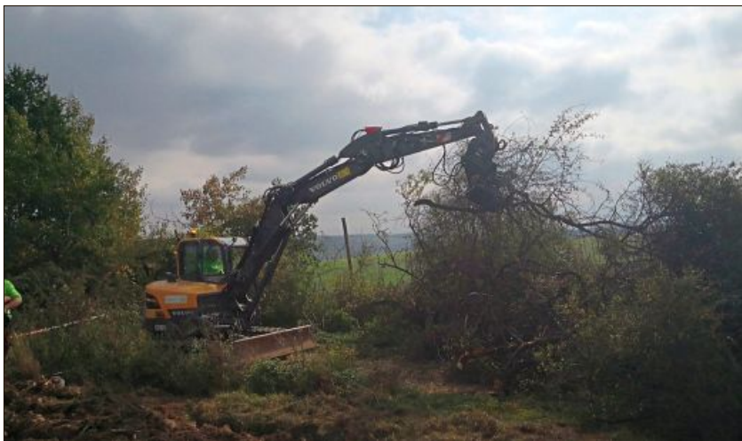
Der Maschinenring Rottenburg Landshut e.V. führte vor, wie eine vergreiste Hecke auf Stock gesetzt wird.
